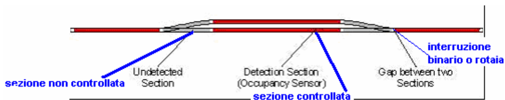
Figura16: sezione di rilevazione e sensore di occupazione
